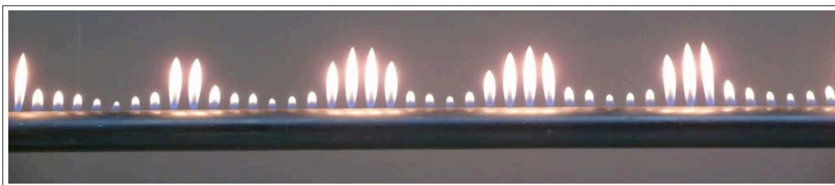
Abbildung 2: Stehende Welle im Rubens - Flammenrohr
