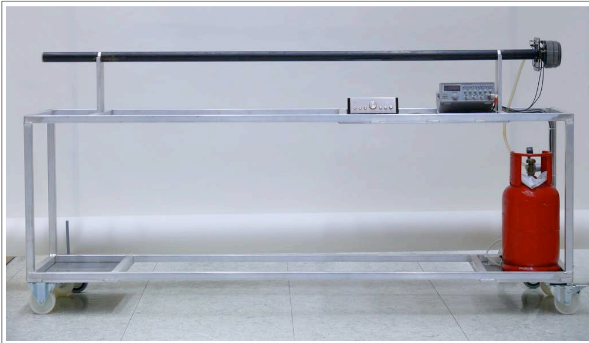
Abbildung 1: Experimenteller Aufbau zum Rubens - Flammenrohr. Der Lautsprecher befindet sich am rechten Ende des Rohres.
